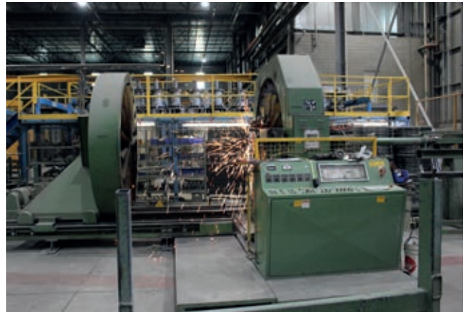
Одна из двух установок твк для сварки арматурных каркасов, используемых на заводе в Оквилле
