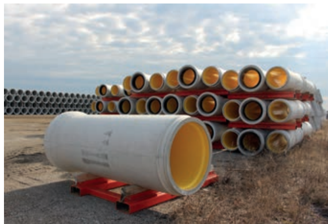
Для хранения и последующей транспортировки на стройплощадку компания Con Cast Pipe построила специальную вспомогательную стойку
