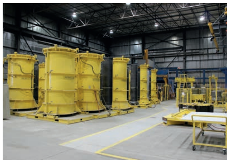
Склад форм на производственной линии Perfect Pipe на заводе Con Cast Pipe
