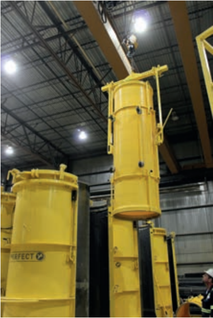
При помощи крана подготовленная футеровка доставляется к форме и насаживается на сердечник с варьируемым диаметром
